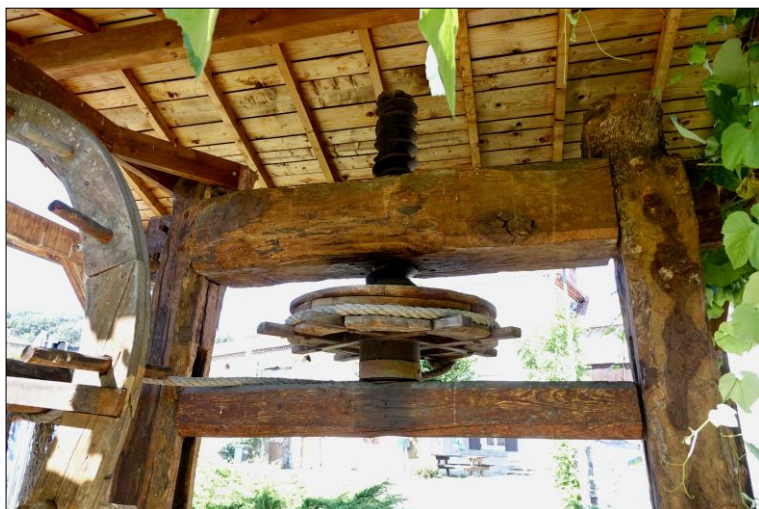
Presse à raisin avec vis en bois et roue verticale
