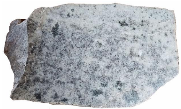
Granulite gris bleuté à structure équante constituée de quartz, feldspath cordiérite pinitisée
