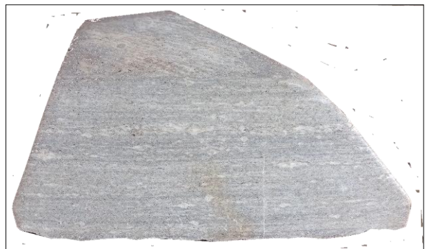
Echantillon de méta-pélite 15 cm par 10 montrant une foliation bien marquée et une linéation sur le dessus. Les feldspaths sont étirés dans le plan de foliation
